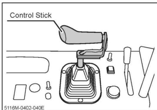
1. Schieben Sie den Bedienhebel (Control Stick) langsam in die "Leerlauf"-Stellung.
