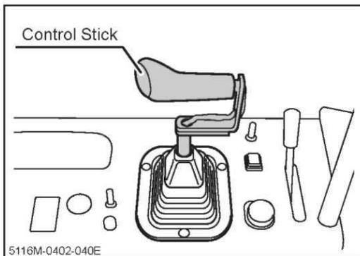
4. Stellen Sie sicher, dass der Bedien-hebel (Control Stick) in seiner Ausgangsstellung ist.
