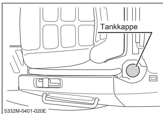
2. Öffnen Sie die Tankkappe und füllen Sie den Tank mit Treibstoff.
