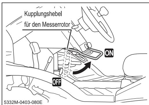
5. Kuppeln Sie den Messerrotor mit dem Kupplungshebel ein.
