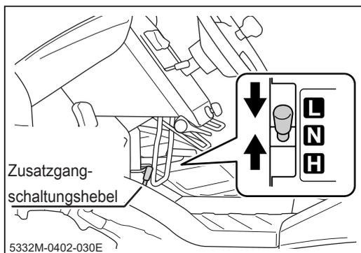
3. Stellen Sie sicher, dass der Hebel der Zusatzgangschaltung auf [N (neutral)] steht.
