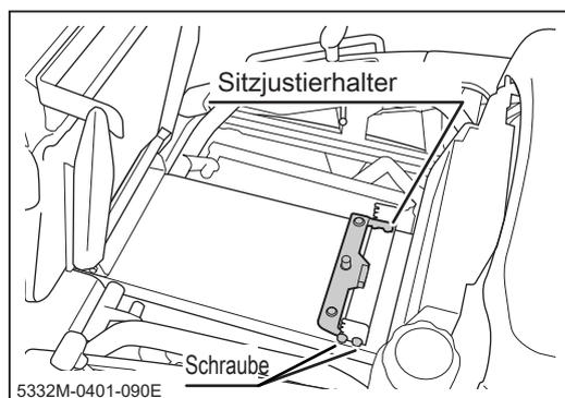
3. Entfernen Sie die vier Schrauben, die den Sitzkontaktschalter befestigen.
