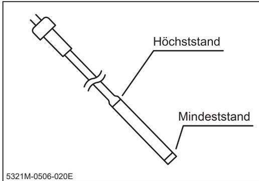
5. Lesen Sie den Ölstand am Peilstab ab. Der angezeigte Ölstand sollte sich zwischen dem markierten Mindest- und Höchststand befinden. Füllen Sie bei zu niedrigem Stand Öl nach.
