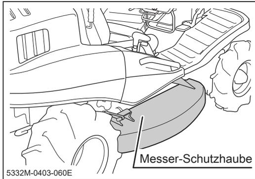
1. Gehen Sie sicher, dass die Messer-Schutzhaube geschlossen ist.
