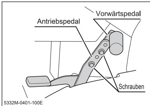
1. Entfernen Sie die beiden Schrauben, die das Vorwärtspedal am Antriebspedal befestigen.
