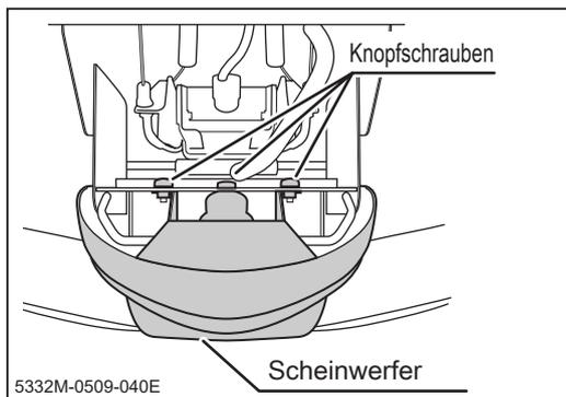
4. Entfernen Sie die 3 Knopfschrauben zum Befestigen des Scheinwerfers. Sie können dann den Scheinwerfer entfernen.
