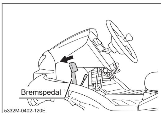
4. Treten Sie auf das Bremspedal, um die Bremspedalsperre außer Kraft zu setzen.
