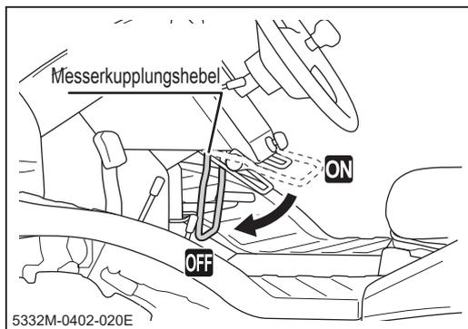
2. Versichern Sie sich, dass sich der Messerkupplungshebel in der [AUS]-Stellung befindet
