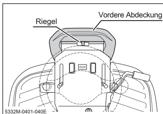
1. Zum Entriegeln der vorderen Haube müssen Sie an der vorderen Haubenkante ziehen.
