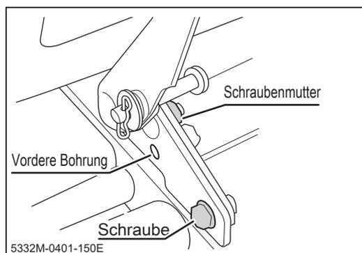
3. Lockern Sie die Schraubenmutter (links und rechts) der Befestigungsscharniere für den Sitz.
