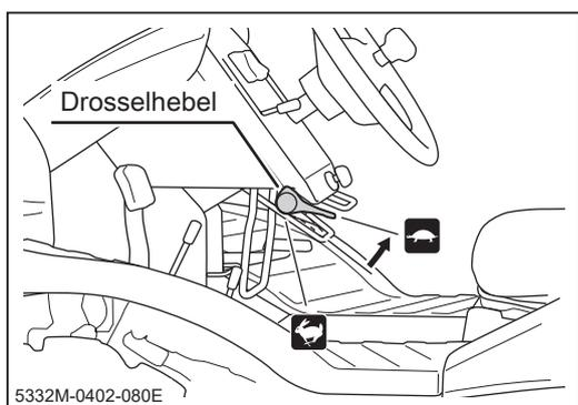
6. Stellen Sie sicher, dass der Drosselhebel auf [↶] (langsam) steht. Bewegen Sie den Drosselhebel 1/3 des Weges zur [↷] (schnell)-Stellung in kaltem Wetter unter 10 Grad Celsius und bevor der Motor ruhig läuft.
