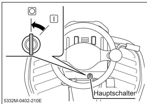
5. Schalten Sie den Motor mit dem Hauptschalter ab. Der Hauptschalter ist jetzt in der [ O (AUS) ]-Stellung. Ziehen Sie den Zündschlüssel ab.
