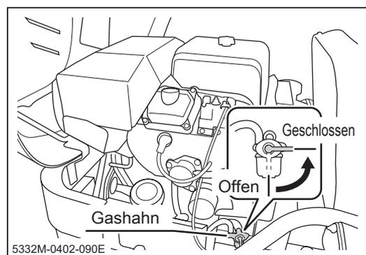
4. Öffnen Sie die Motorhaube und schließen Sie den Gashahn. Schließen Sie die Motorhaube.
