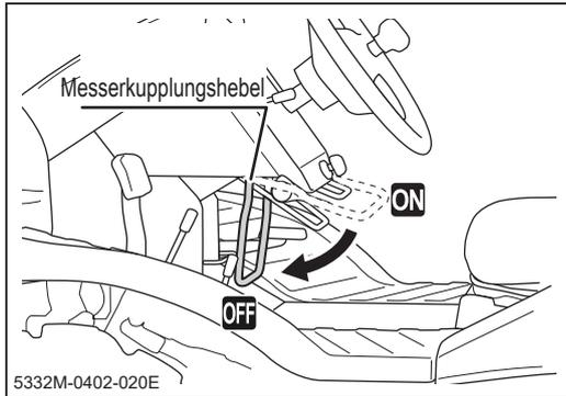
7. Schieben Sie den Kupplungshebel für die Messer in die [AUS]-Stellung. Das stoppt die Messer.
