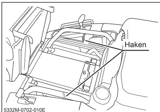
1. Heben Sie den Fahrersitz der Maschine an.
