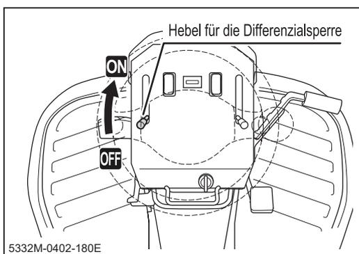
1. Schieben Sie den Hebel für die Differenzialsperre in die [AN]-Stellung.
