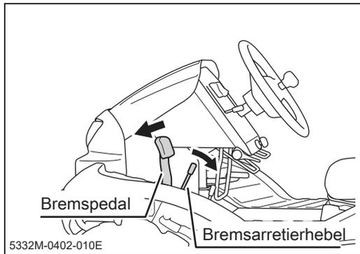
1. Überprüfen Sie, ob Sie die Bremse gesetzt haben. Wenn dies nicht der Fall ist, müssen Sie die Bremse treten und arretieren.
