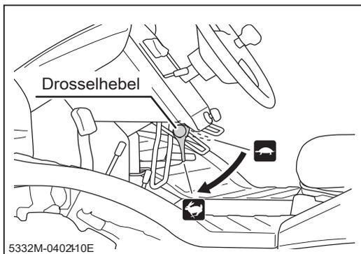
2. Stellen Sie den Drosselhebel auf [
