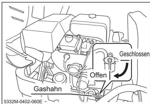
5. Öffnen Sie die Motorhaube (s. Seite 51) und öffnen Sie dann den Gashahn.
