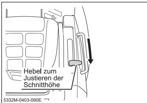
8. Schieben Sie den Hebel für die Schnitthöheneinstellung so hoch wie möglich.
