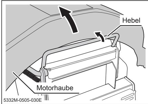
1. Ziehen Sie am Hebel, um die Motorhaube zu öffnen.
