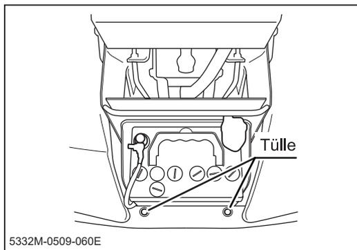
5. Stecken Sie die Projektionen im Boden der Scheinwerfereinheit in die Bohrungen der Tüllen ein, die sich an der Stoßstange befinden. Installieren Sie den Scheinwerfer.
