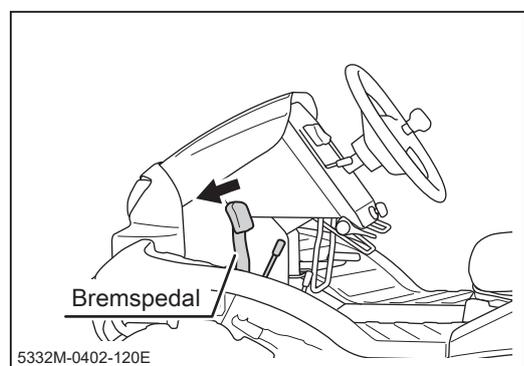
3. Treten Sie auf die Bremse, um die Maschine vollständig anzuhalten.
