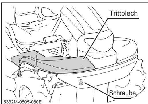
1. Entfernen Sie die 3 Befestigungsschrauben für das Trittblech.
