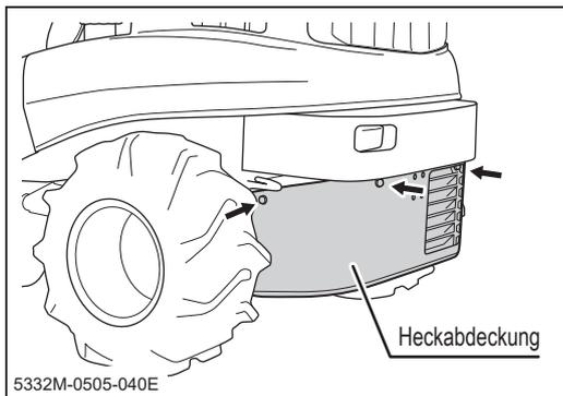
1. Entfernen Sie die 4 Schrauben.
