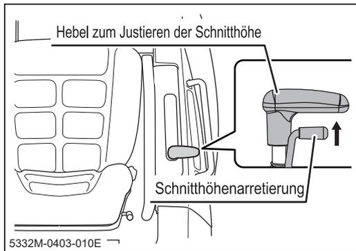
1. Greifen Sie den Hebel zum Justieren der Schnitthöhe, um den Justierhebel zu entsperren.
