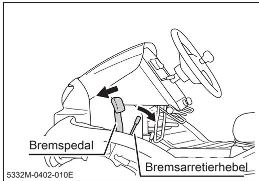
3. Treten Sie auf das Bremspedal und ziehen Sie die Bremssperre hoch. Die Bremse ist jetzt in der gesperrten Stellung arretiert.
