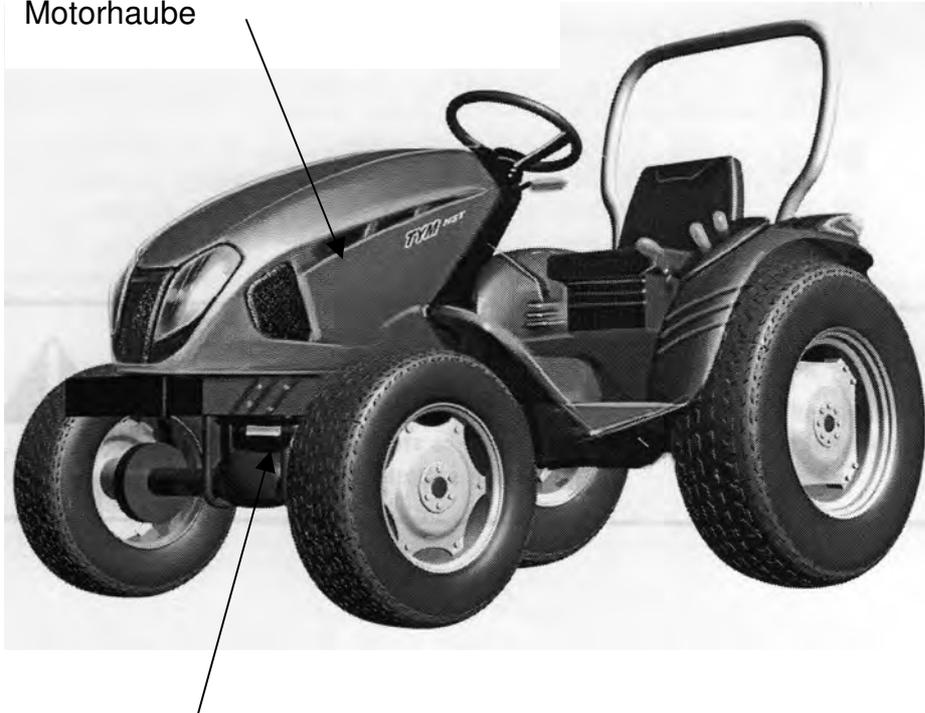
Fahrgestellnummer, geprägt auf eine Platte links der Achse
